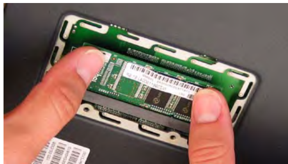
Abbildung 16: Einsetzen des Arbeitsspeichermoduls
