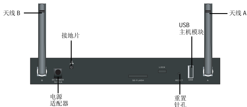
图 5: SSG 5 设备的后面板
