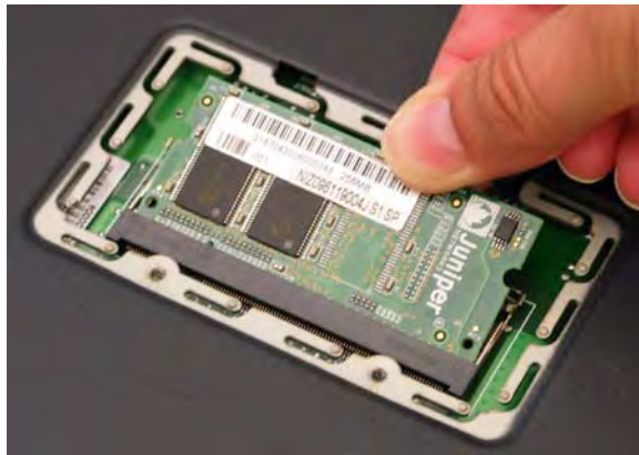
Abbildung 15: Entfernen der Modulsteckplätze
