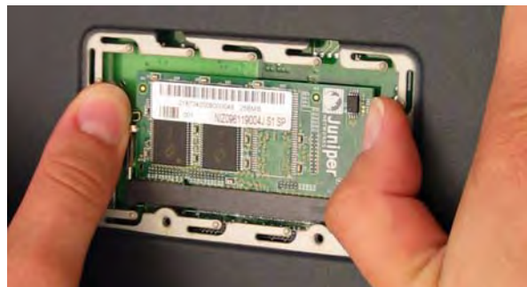
Abbildung 14: Entriegeln des Arbeitsspeichermoduls
