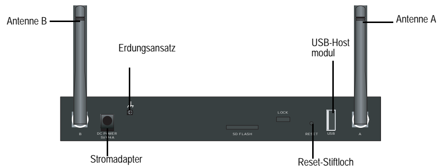
Abbildung 5: Rückseite eines SSG 5-Geräts
