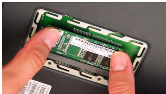
図 16: メモリモジュールの挿入
