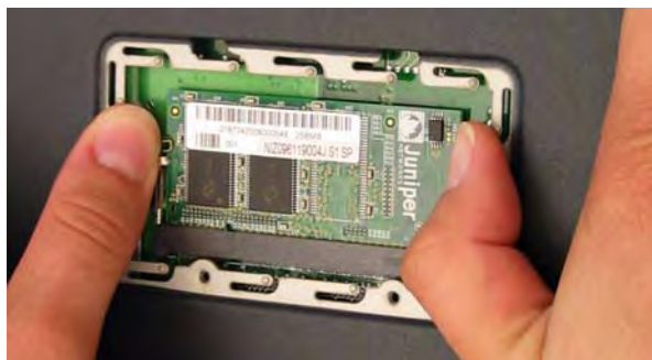
Figura 14: Desbloqueo del módulo de memoria
