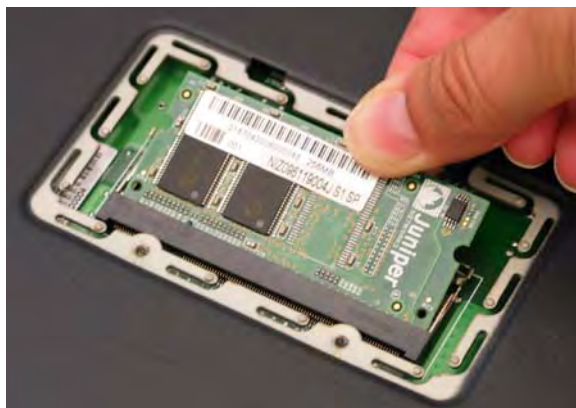
图 15: 取下模块插槽
