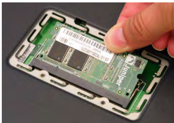
Figura 15: Extracción de las ranuras del módulo
