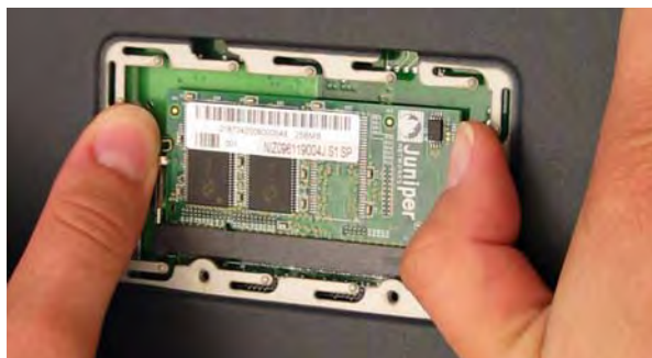
図 14: メモリモジュールのロック解除
