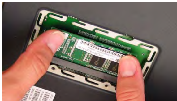
Figure 16 : insertion du module de mémoire
