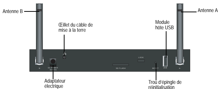
Figure 5 : panneau arrière d'un appareil SSG 5
