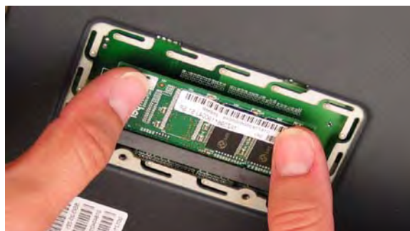
Figura 16: Introducción del módulo de memoria
