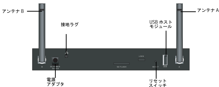
図 5: SSG 5 のバックパネル
