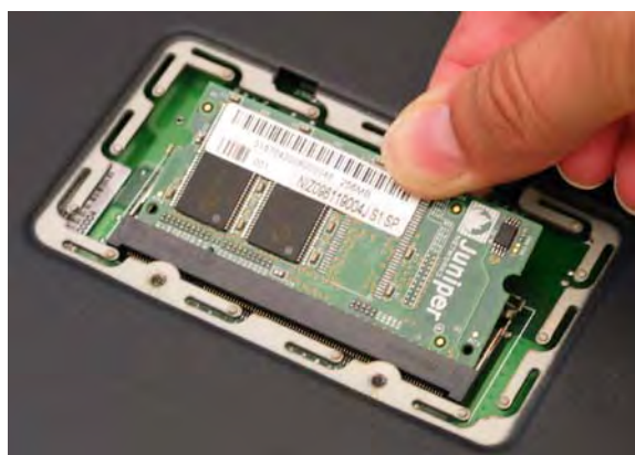
図 15: モジュールスロットの取り外し
