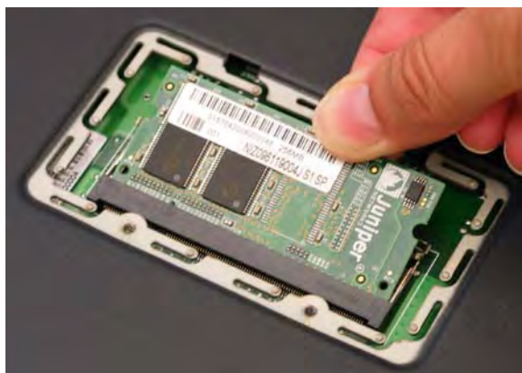
Figure 15 : dépose du module
