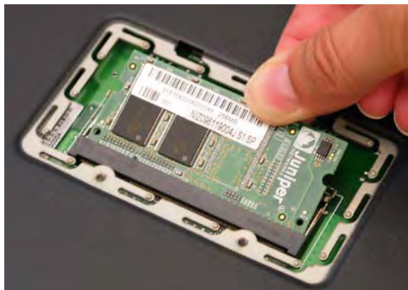
圖 15: 移除模組插槽
