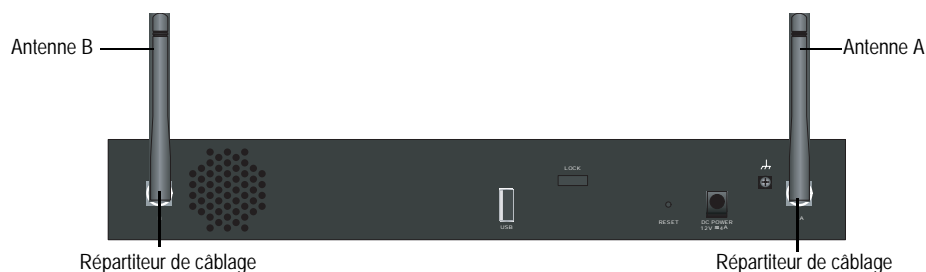
Figure 12 : emplacement des antennes de l'appareil SSG 20-WLAN
