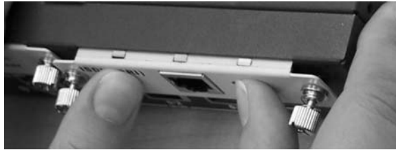
Figure 17 : installation d'un mini-module d'interface physique
