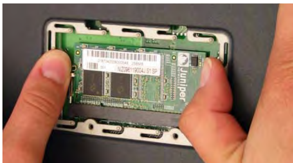
図 19: メモリモジュールのロック解除
