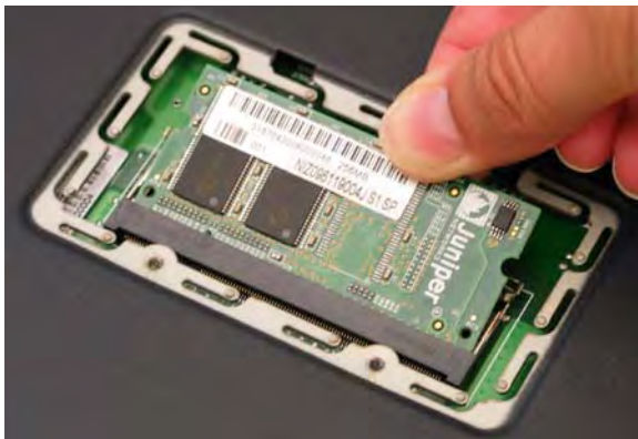
図 20: モジュールスロットの取り外し
