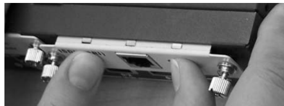
Figure 17: Installing a Mini PIM
