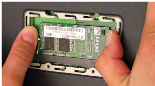
Figure 19 : déverrouillage du module de mémoire
