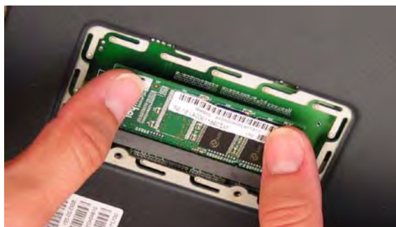
Figure 21 : insertion du module de mémoire
