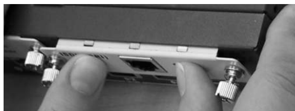
図 17: Mini PIM の取り付け
