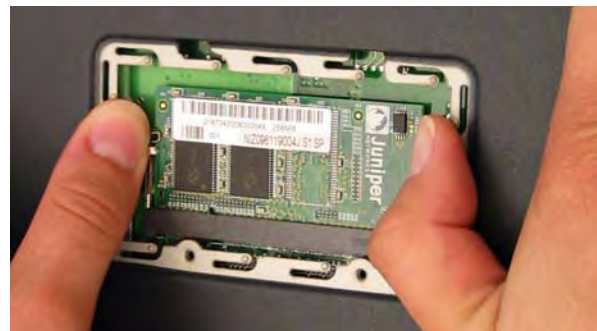
Abbildung 19: Entriegeln des Arbeitsspeichermoduls
