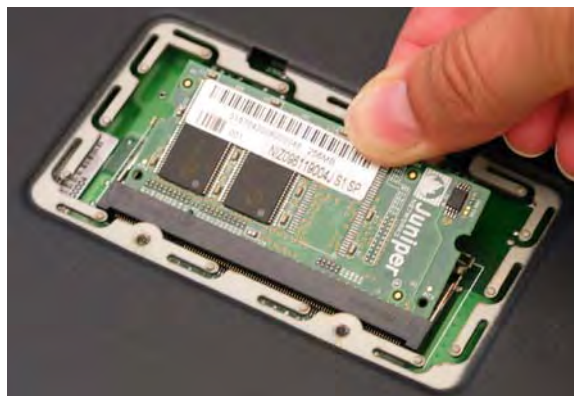
Abbildung 20: Entfernen der Modulsteckplätze
