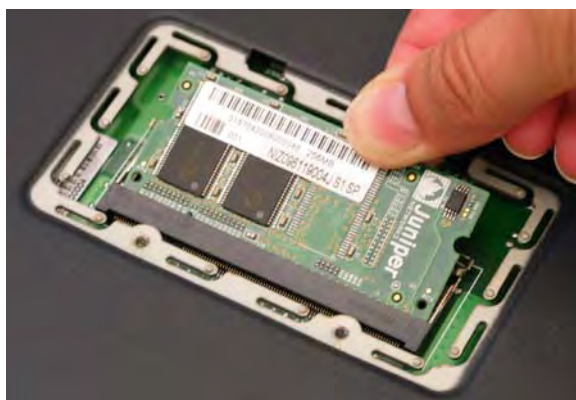
Figura 20: Extracción de las ranuras del módulo
