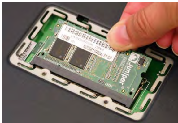
圖 20: 移除模組插槽
