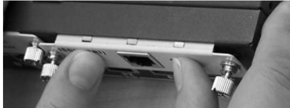
Abbildung 17: Einbauen eines Mini-PIM
