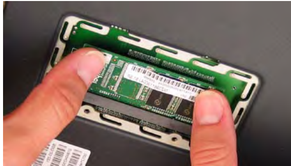
Abbildung 21: Einsetzen des Arbeitsspeichermoduls
