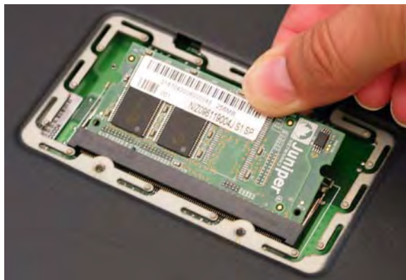
图 20: 取下模块插槽
