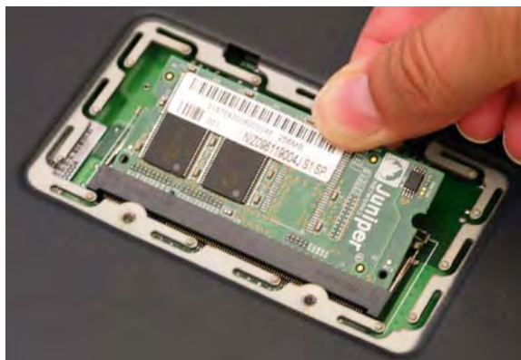
Figure 20 : dépose du module
