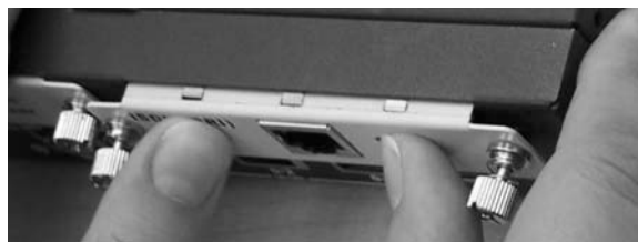
Figura 17: Instalación de un mini PIM
