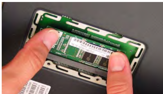
Figura 21: Introducción del módulo de memoria
