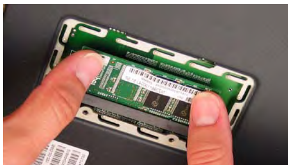
図 21: メモリモジュールの挿入
