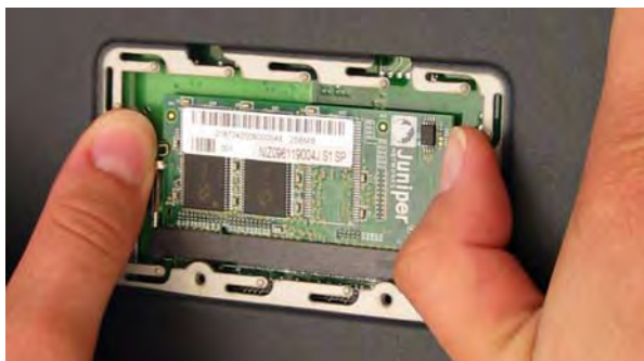
Figura 19: Desbloqueo del módulo de memoria
