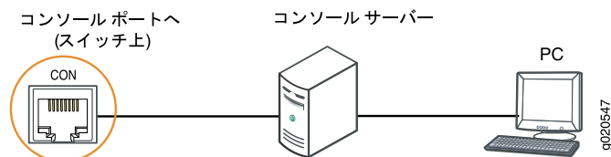
図 42: EX シリーズ スイッチの管理コンソールへの直接接続
