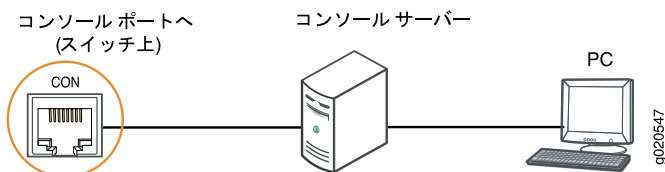
図 63: EX シリーズ スイッチの管理コンソールへの直接接続
