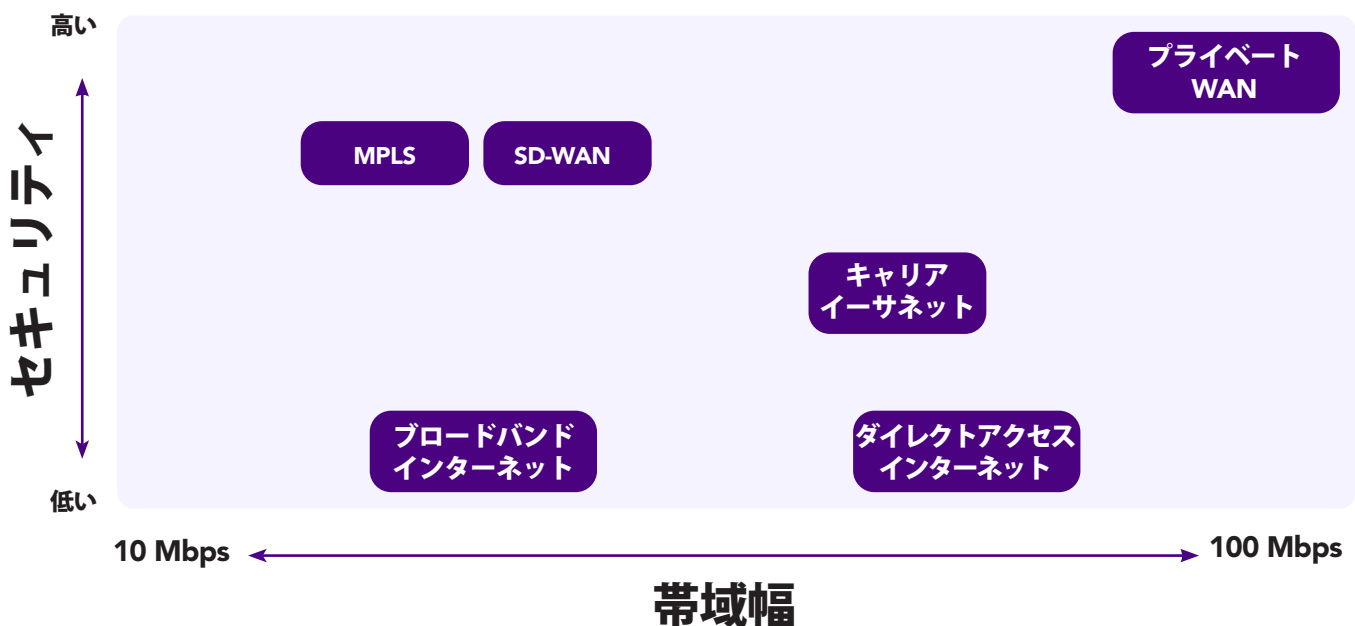
図1：ネットワークサービスと帯域幅およびセキュリティの分布図
