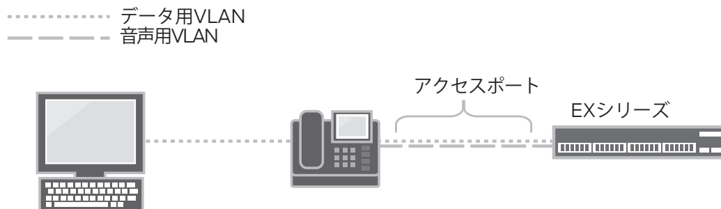
図 4.2 音声 VLAN、IP テレフォニー、および PC が同じスイッチポートを共有している、アクセスポートとして設定されたスイッチポート
