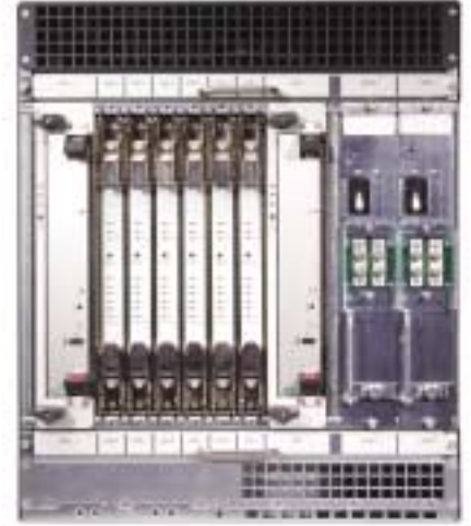
6개의 후면 장착 포워딩 엔진 보드 (Forwarding Engine Boards)는 대기 인터페이스 모듈 없이도 새시에 설치된 모든 PIC에 이중 포워딩 성능을 제공합니다.
