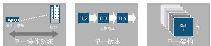
图5：Junos操作系统使用单一源代码、严格遵守版本流程，并采用单一模块化架构
